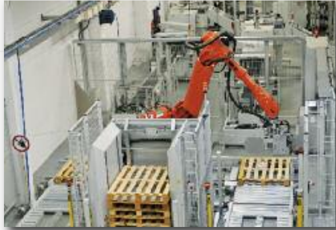
Vollautomatische Roboterpalettierung inklusive Palettenmagazin, Zwischenbogen, Stauplatz für Vollpaletten, automatische Kreuzumreifung und elektrostatische Verblockung.
