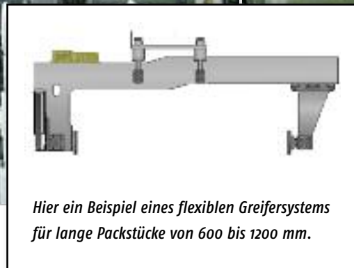
Die Verstelleinheiten der Multipackgreifer werden über Servoantriebe von Berger+Lahr sowie über intelligente Feldbus-Ventilinseln verstellt.
